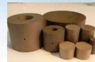
TiB2系導電性セラミックス製焼結型
