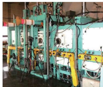
5チャンバー式トンネル型SPS生産システム
