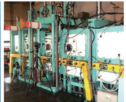
5チャンバー式トンネル型SPS生産システム (超硬合金製造用ライン)
