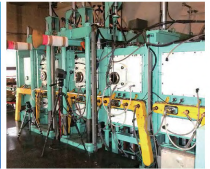
5チャンバース式トンネル型SPS生産システム (超硬合金製造用ライン)
