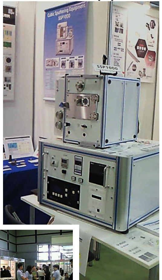
▼キュービック・スパッター装置 JASCグループ：(株)菅製作所製
