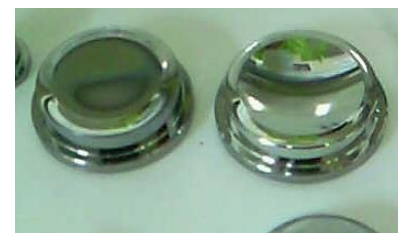
図5 \phi 55mm 大形ガラスレンズ金型例 (プロジェクター/デジタル一眼レフカメラ用)
