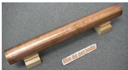
図10 長尺純銅パイプの固相拡散接合体
