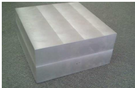
図8 大形アルミブロックの固相拡散接合体
