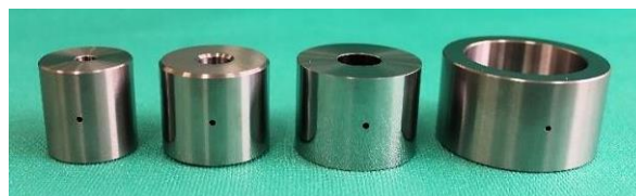
図3 SPS 焼結用バインダレス超硬型(ダイス)例
