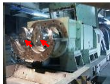
図4 押出成形機のスクリー部 (矢印部、右曲りと左曲りの2本)
