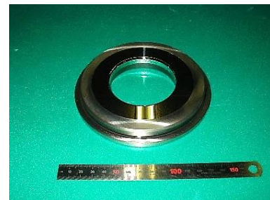
図 1 低バインダ超硬材の製缶金型
