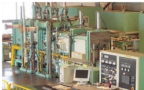
図13 北海道SPSセンターの生産用焼結設備外観
