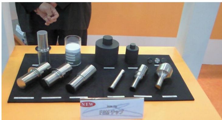
▲SPS 法で作製した各種 ZrO 2 -Ti 合金 FGM ホーンチップ先端工具と FGM 原料粉末および SPS 用グラファイト型
