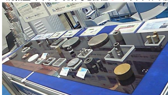
▼ファインセラミックス・傾斜機能材料 WC/Co 系超硬・TiB 2 焼結型・チタン多孔体など各種 SPS サンプルの展示
