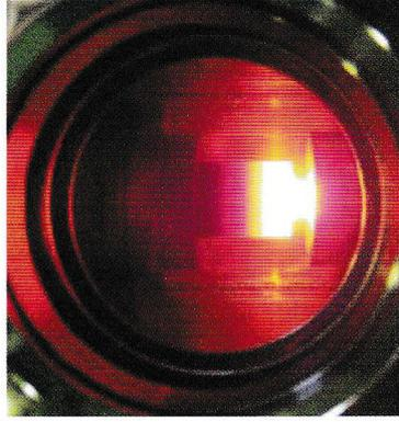
真空チャンバー内に配置されたグラファイト治具に挿入された粉体及びチタンバルクは、SPS 焼結装置から作り出される、数千アンペアのパルス電流を加える事によりグラファイト治具が自己発熱で高温になり、治具内焼結が行われます。
