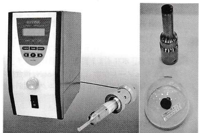
図 16 超音波ホモジナイザー (左) と FGMs ホーン (右) (写真提供: 三井電気精機株式会社)
