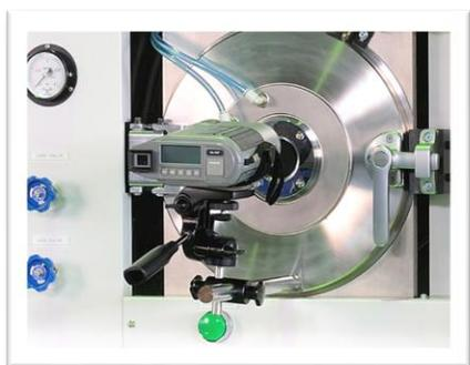
非接触型温度計測システム
