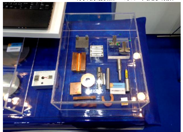
▼WC/Co 系超硬・pure-WC バインダレス超硬による非球面ガラス レンズ金型・多孔体・ファインセラミックス・傾斜機能材料など ▼各種 SPS 接合体サンプルの展示 (JASC グループ:(株)諏訪熱工業より提供品)
