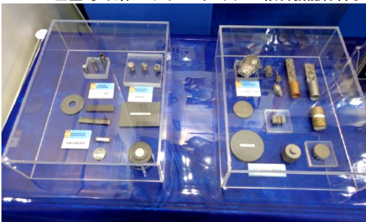
▼WC/Co 系超硬・pure-WC バインダレス超硬による非球面ガラス レンズ金型・多孔体・ファインセラミックス・傾斜機能材料など ▼各種 SPS 接合体サンプルの展示 (JASC グループ:(株)諏訪熱工業より提供品)
